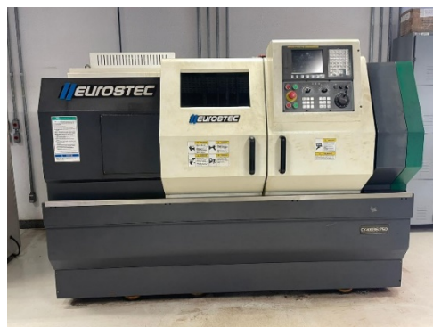
Figura 1. Torno CNC Eurotec usado no processo de usinagem.
