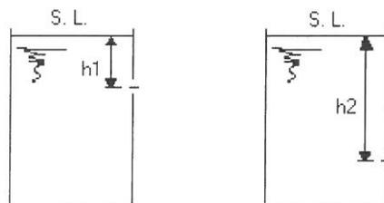
Fig. 2 – orifício num reservatório
