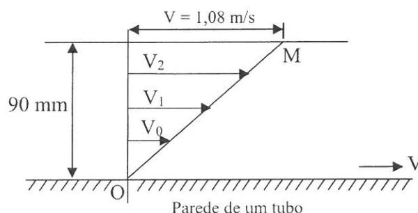
Figura 3 – Distribuição de velocidades do escoamento sobre uma placa.
