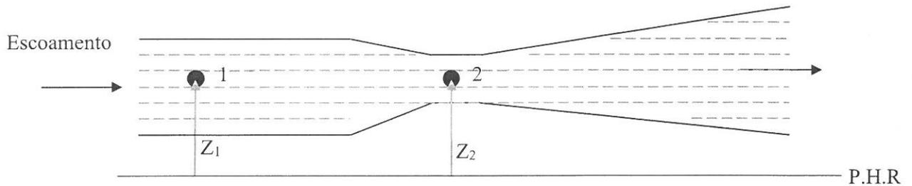
Figura 2 - Medidor VENTURI
