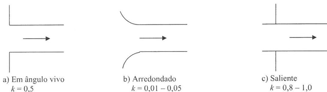
Fig. 6.2 - Coeficiente de perda de carga  $k$  para entrada em um tubo.
