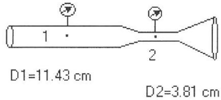
Fig. 3 – Medidor Venturi
